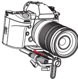
5.安装跟焦齿环。将跟焦齿环解开，套在相机镜头的对焦环（变焦环）适合位置，然后拉紧卡住镜头对焦环（变焦环）即可。
