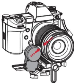
①务必使跟焦齿环与镜头对焦环（变焦环）卡紧，确保转动跟焦齿环的时候镜头对焦环（变焦环）能同时转动。
